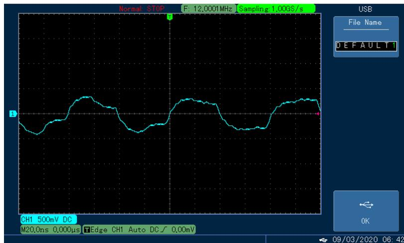
Рисунок 4. Форма сигнала на выходе синтезатора при частоте 12 МГц
