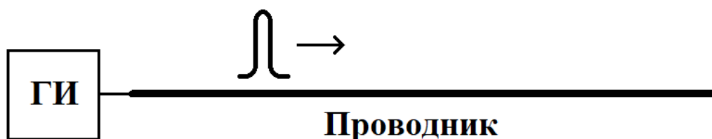
Рисунок 1. Конструкция, которую предлагается рассматривать в качестве импульсного электромагнитного двигателя
