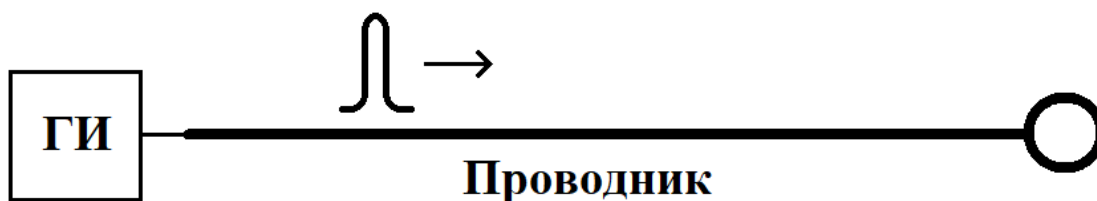
Рисунок 2. Конструкция импульсного электромагнитного двигателя с шаром на конце проводника
