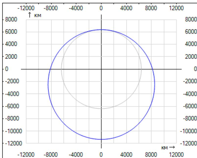
Рис. 1. Траектория снаряда, запущенного с поверхности планеты в горизонтальном направлении со скоростью, равной 0,8 скорости освобождения.
